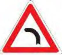
*Il segnale raffigurato preannuncia, di norma a 150 metri, una curva pericolosa*
