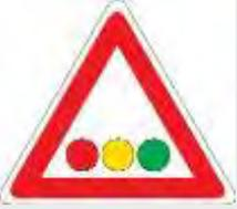
*Nel segnale raffigurato, il disco giallo può essere sostituito da una luce gialla lampeggiante*
