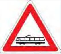
*In presenza del segnale raffigurato bisogna fare attenzione alla possibile diminuzione di aderenza delle ruote del veicolo se si frena sui binari*
