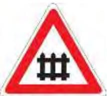
*Il segnale raffigurato preannuncia un passaggio a livello con barriere o con semibarriere*
